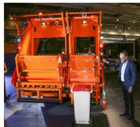
Zabudowa nr 10.000 to 2-komorowa konstrukcja pozwalająca na odbiór różnych frakcji odpadów na tej samej trasie. Podczas wydarzenia prezentował ją Rainer Rohler, prezes zarządu ZOELLER TECH Sp. z o.o.
