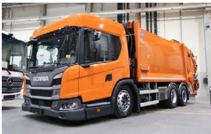
Jubileuszowa zabudowa została zamontowana na wyjątkowym podwoziu. Jest nim Scania L320 wyróżniająca się kabiną niskowejściową, a w egzemplarzu zamówionym przez NordRen – także funkcją przykłąku.
