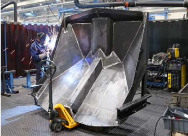
W zakładzie ZOELLER TECH w Rekowiu Górnym główne elementy każdej śmieciarki, tj. skrzynia ładunkowa, płyta wypychająca i odwłok są spawane na trzech osobnych liniach, po czym trafiają do komory śrutowniczej.
