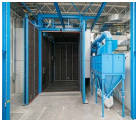
W nowoczesnej komorze śrutowniczej przygotowanie nawet tak dużego elementu, jakim jest skrzynia ładunkowa śmieciarki zajmuje tylko ok. 20 min.
